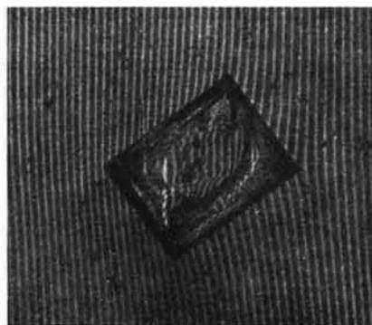
Fig. 5. Cristal de  $\text{NaClO}_3$  en voie de croissance dans sa solution sursaturée (6 g./100 g. de solution). Franges de lames à ondes multiples obtenues avec des lames ayant un pouvoir réflecteur de 80% et le doublet jaune du sodium.
